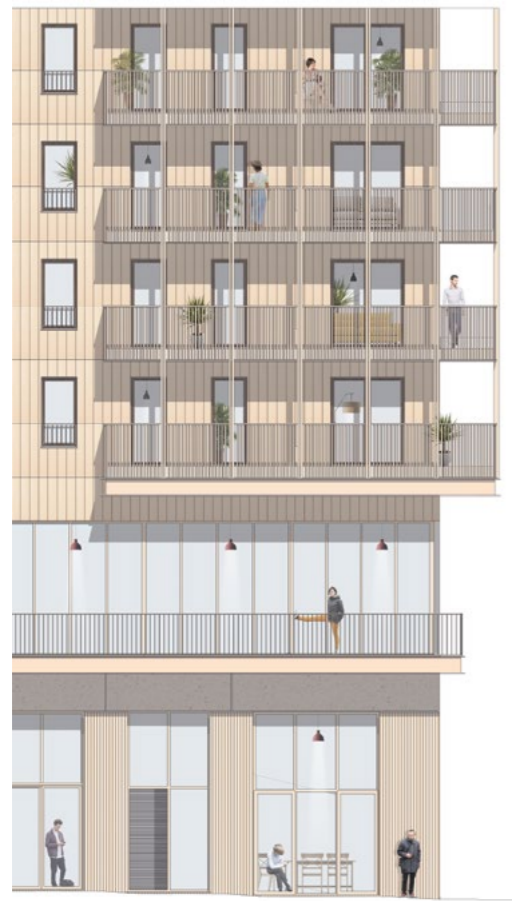
Façade du bâtiment de coliving E2B2, avec espaces partagés au 1er étage, bardage terre cuite
