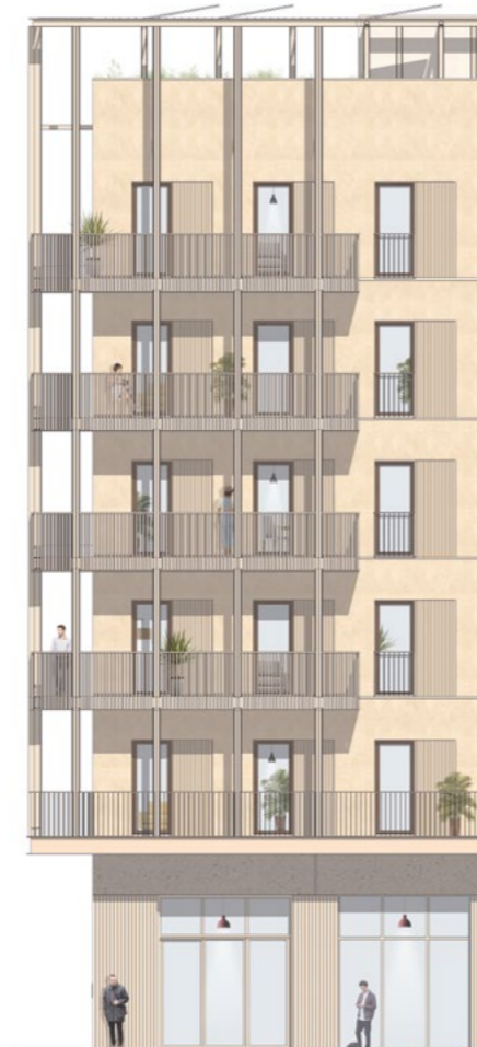
Zoom sur bâtiment en structure bois E2B3 sur socle commun en béton préfabriqué
